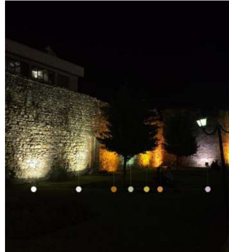
Unifikim i Plotë i Ngjyrës, Fuqisë dhe Këndit Shpërndarës të Dritës për çdo Ndrinëues të Murit të Kalasë.
